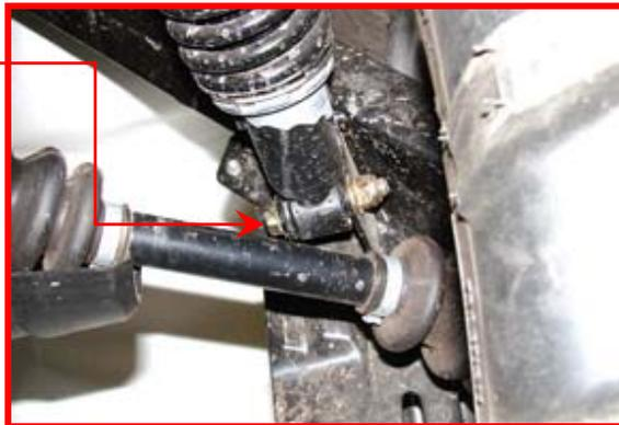
12. Enfillez le boulon OEM, que vous venez de retirer, à travers le support inférieur en métal Kolpin (le plus petit des deux supports) fourni dans le nécessaire et remplacez le boulon à travers l'amortisseur. Ne serrez pas encore à fond car il faudra pivoter le support pour l'aligner sur le support supérieur.
