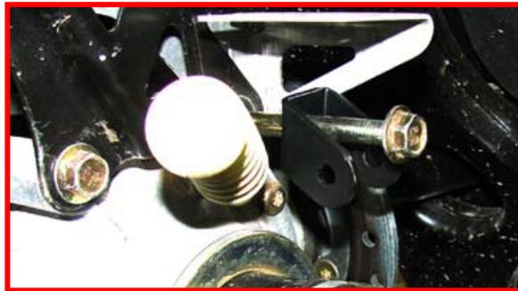
Assurez-vous que l'écrou est au-dessus de cette canalisation de frein, située sur le côté arrière gauche de la machine.
