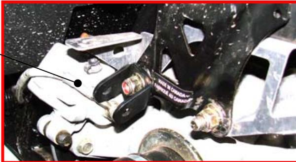
Alignez le support supérieur Kolpin et le support inférieur Kolpin à l'aide de la tige de blocage.
