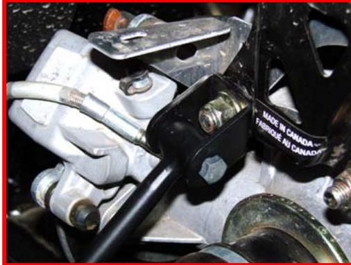
17. Puis faites pivoter la tige de blocage pour l'aligner sur le support inférieur sur l'amortisseur. À l'aide de la cheville de blocage fournie, fixez la tige de blocage sur le support inférieur. Ensuite, serrez le support inférieur à fond.
